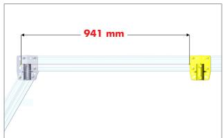
Aflojar los tornillos de punta de los soportes y, a continuación, introducir los postes en las posiciones previstas
