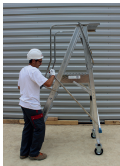
Instalación de las empuñaduras para facilitar el desplazamiento (2 tornillos hexagonales en los extremos de cada guarda-cuerpos, 4 en total + una llave Allen)
