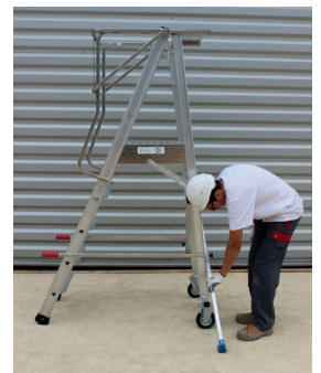
Instalar los estabilizadores
