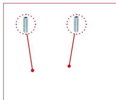
**2** - Insertar la pieza de unión en las ranuras del rodapié y unir los 2 rodapiés con 2 tornillos espárrago M8x10.
