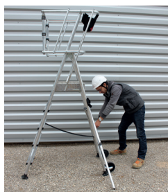
Tirer les stabilisateurs jusqu'au sol, puis les bloquer en retournant la molette
